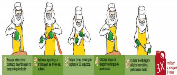
Figura 2 – Preparo da embalagem para a realização da tríplice lavagem
