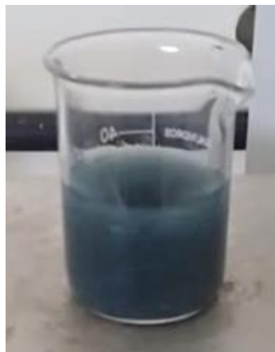
Figura 2 - Amostra da solução de AM com carvão ativado sob agitação.
