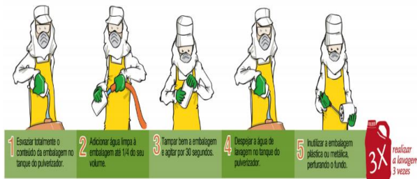
Figura 2 – Preparo da embalagem para a realização da tríplex lavagem
