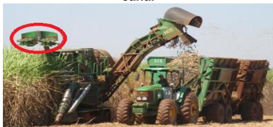
Figura 3 - Despontador da colhedora de cana.
